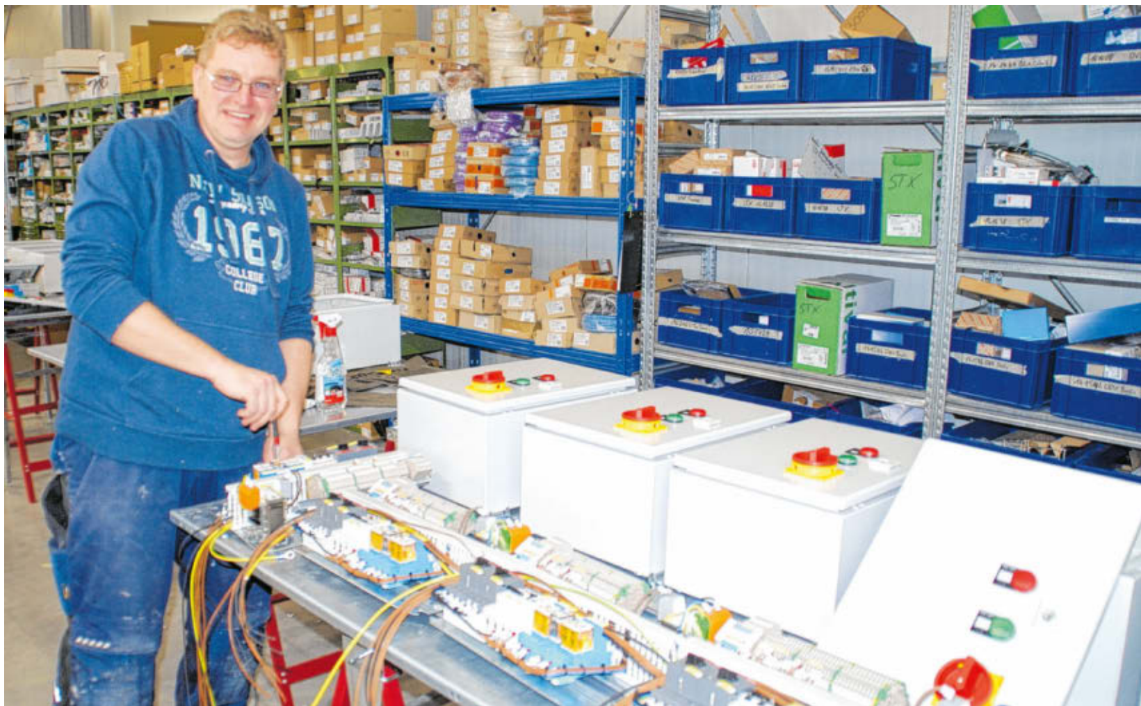
Michael Brümmer verdrahtet in der Werkstatt Schaltschranke für Schiffsklimaanlagen.
